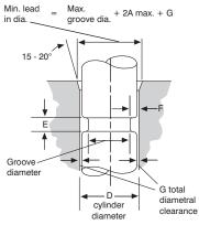
Max. groove dia. = D min. - 2F min. Min. groove dia. = D max. - 2F max.
